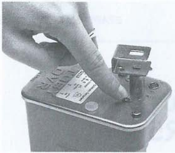
Εικόνα 1 : Ενεργοποίηση της βαλβίδας εξαγωγής με επανειλημμένες πιέσεις πάνω στο ζιγκλέρ (2)
